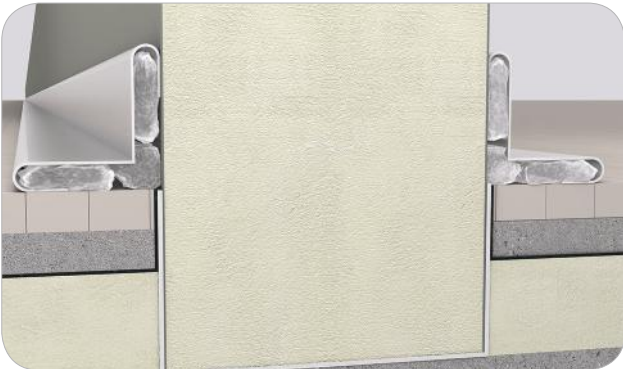
Soğuk Oda İç Köşe Detayı / Cold Room Inner Corner Detail
